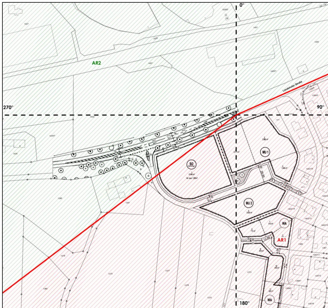
Abbildung 1: Darstellung der Richtungssektoren und des Bezugskoordinatensystems
